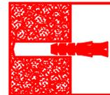
Beiliegendes Befestigungsmaterial eignet sich nur für Massivwände.
